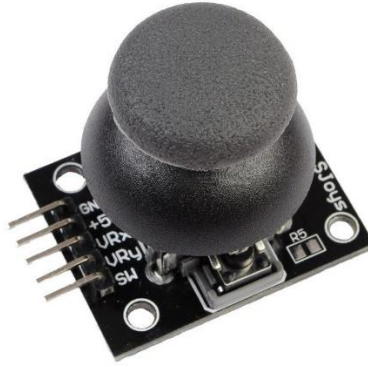
Rysunek 3. Wykorzystany w ćwiczeniu dwuosiowy manipulator analogowy – joystick. Do wejścia 5V podłączyć należy napięcie zasilania MCU czyli 3.3V ! .
