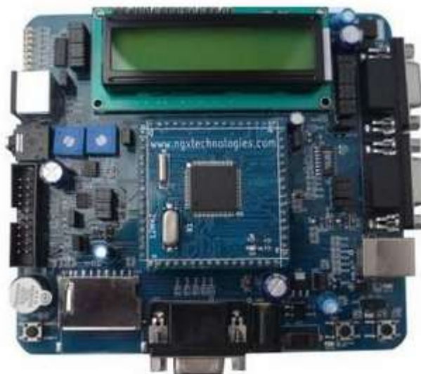
Rys. 2.10. Zestaw uruchomieniowy Blueboard-LPC1768 COMBO produkcji NGX z procesorem LPC1768 (Cortex-M3)
