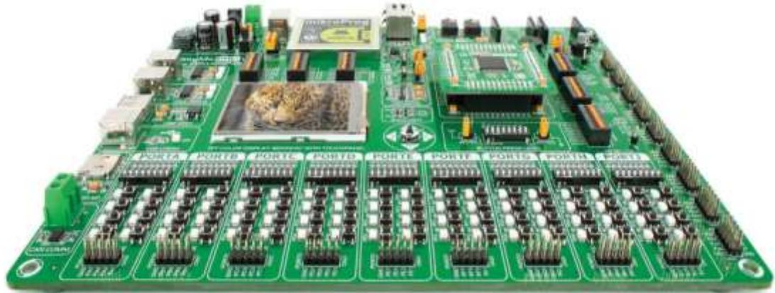
Rys. 2.7. Zdjęcie zestawu ewaluacyjnego EasyMxPRO™v7 for STELLARIS® ARM®
