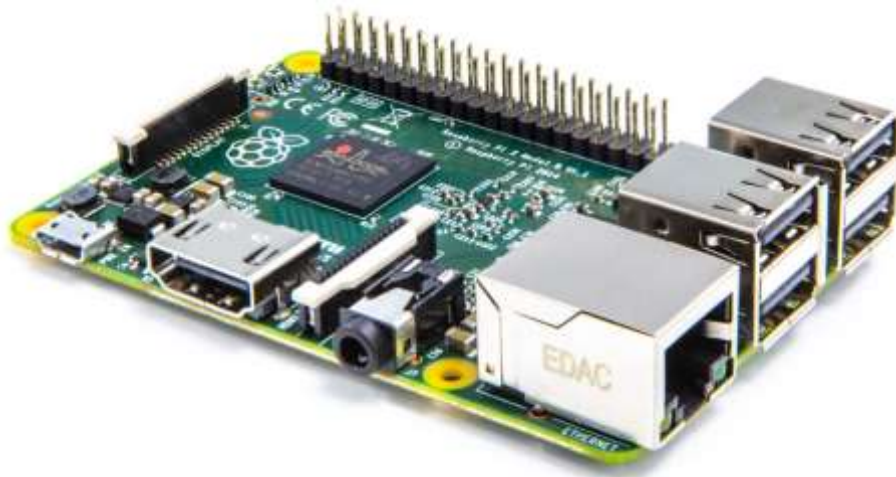
Rys. 2.8. Zdjęcie komputera Raspberry Pi model B2, z procesorem z rdzeniem Cortex-A7
