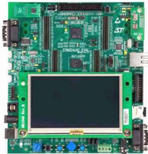
Rys. 2.9. Zestaw ewaluacyjny STM32429I-EVAL produkcji STMicroelectronic z procesorem STM32F429 z rdzeniem ARM®Cortex™-M4, w sklepie KAMAMI w cenie 1962 PLN brutto
