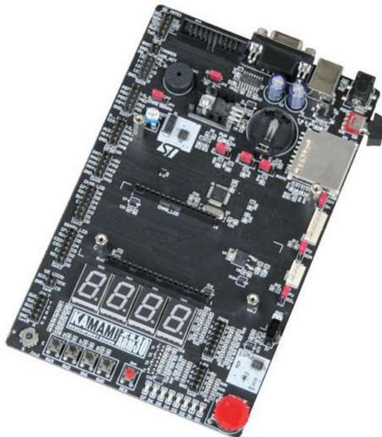
Rys. 2.12. Zestaw uruchomieniowy ZL30ARM dla mikrokontrolerów STM32F103 (Cortex-M3)
