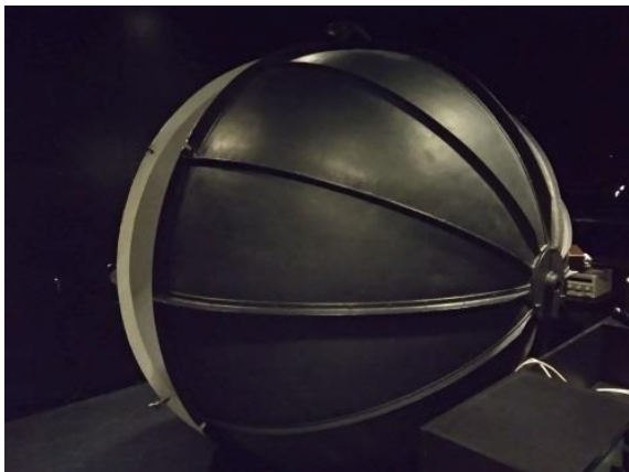
Rys. 1. Typowe konstrukcje lumenomierzy kulistych (fot. K. Skarżyński)
