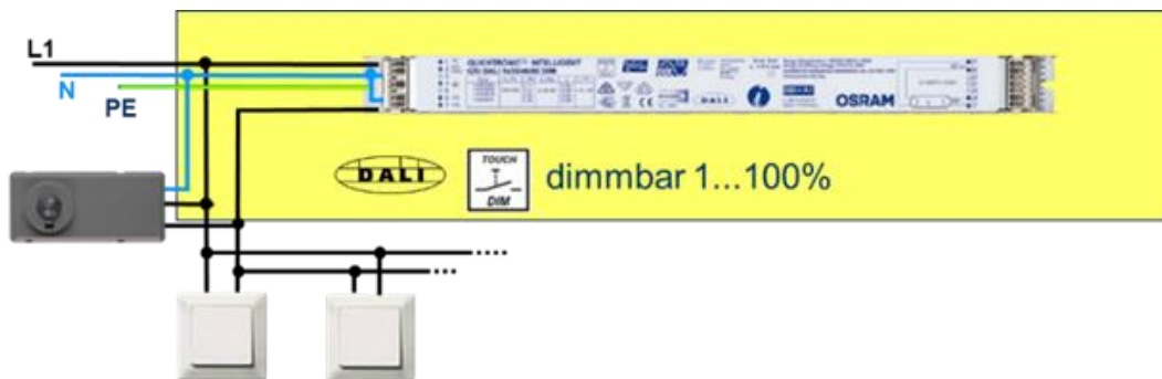
Rys. 2. Ogólny schemat systemu Touch Dim [2].
