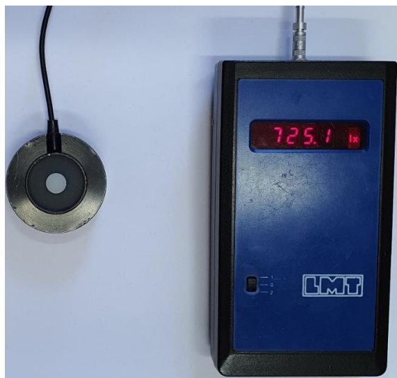
Rys. 3. Luksomierz przenośny Pocket Lux 2 firmy LMT
