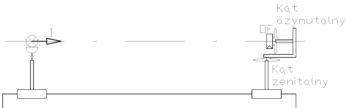
Rys. 7. Układ do wyznaczenia rozkładu przestrzennego czułości głowicy fotometrycznej.
